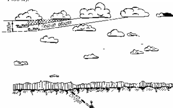
Рис. 34. Для увеличения сектора видимости перед стартом необходимо находиться под облачностью на 150—200 м ниже ее основания
